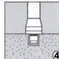
④ アンカーの緩みがないことを確認の上、仮設置して路面との間に浮き(隙間)などがないことを確認してください。
