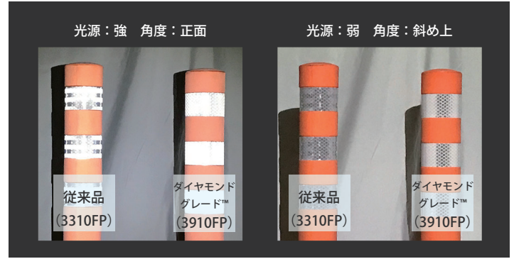
光源の強度を強弱させ、角度変化による反射輝度を捉えた比較写真
